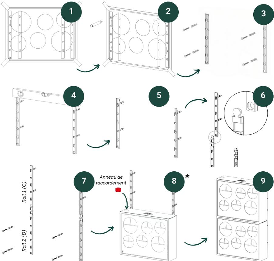
\*Il faut toujours insérer l'anneau de raccordement dans l'orifice d'écoulement de la boîte inférieure.
